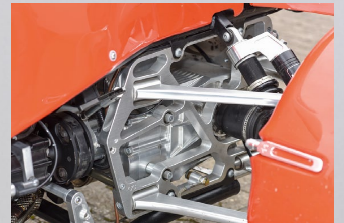
Schweizer Präzision: Die Frästeile der Radaufhängungen, hier am Hinterrad-Differenzial, stammen vom Schweizer Quadbauer Grüter und Gut
