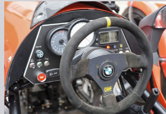
Originale BMW K1300-Instrumente. Was nicht adäquat als Automobil-Rennsportzubehör zu haben war, wurde selbst gebaut
